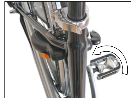
Pedal für Hinterradbremse mit Rücktrittbremse
